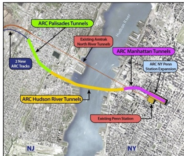
Het tunneltracé naast de huidige spoortunnel onder de Hudson.
