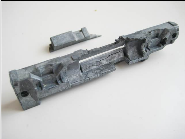
Defect Intermountain F3 frame, let op de scheuren.
