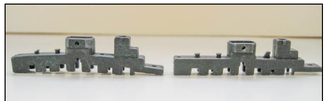
Twee Y6B drijfwerk frames (2-8-8-2). Rechts correct, links nogal krom.
