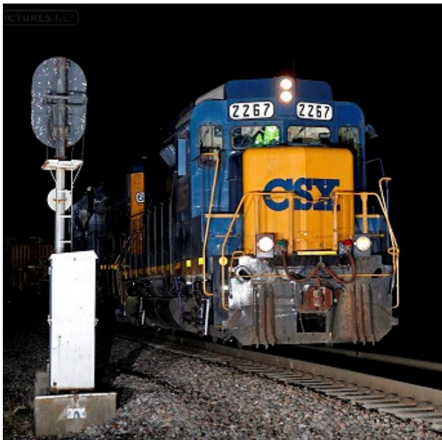
CSX 2267 is een voormalige GP30 die als road slug is ingezet.
