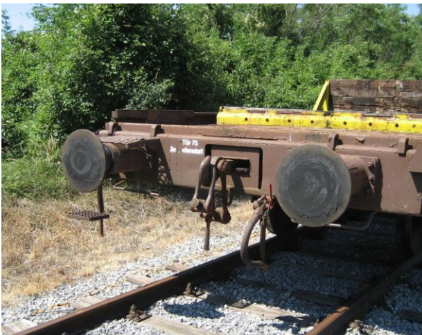
Figuur 1: wagon met buffers en koppelstang
