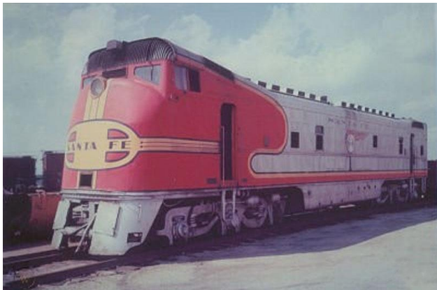
De verbouwde A-unit #1 met Bulldog neus.
